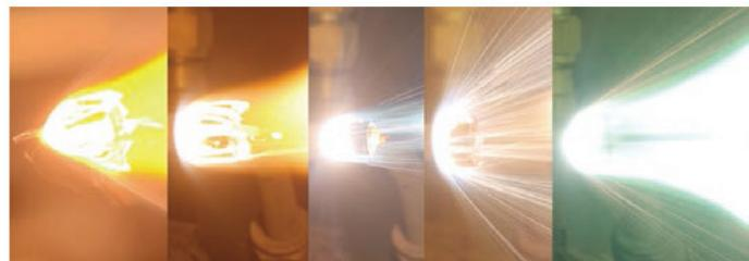
JAXA・宇宙科学研究所の惑星大気突入環境模擬装置（アーク加熱風洞）を用いた流星アブレーション（加熱で高温になった固体表面が溶けて爆発的に剥ぎ取られる）の様子。組成の違いにより、色が異なる様子が分かる。
